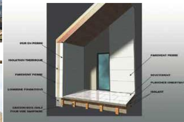
Principe constructif du module Pierre Bio'Mur.
